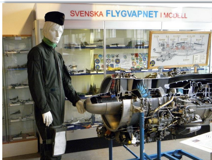
RM9 motor uppskuren vid entrén. (Satt tidigare i SK60).
